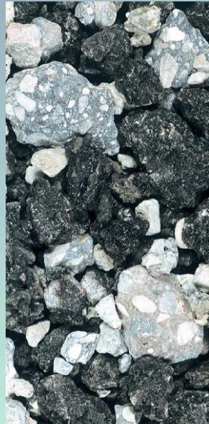
RAB - Recycliertes gebrochenes Asphalt/Beton-Mischgranulat (Asphalt und Beton)
