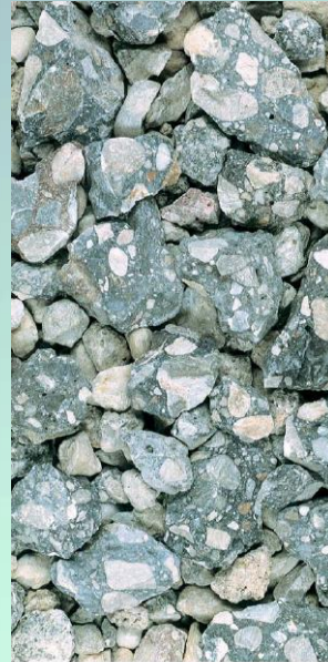
RB - Recycliertes gebrochenes Betongranulat (vorwiegend Beton)
