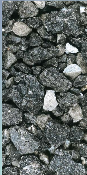
RA - Recycliertes gebrochenes Asphaltgranulat (vorwiegend Asphalt)
