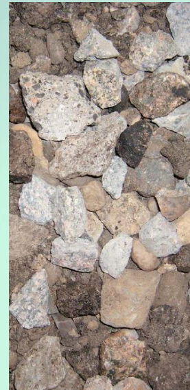
RG - Recycliertes Granulat aus Gestein (natürliches und/oder recyciertes) mit einem Anteil von mindestens 50% sowie Beton und/ oder Asphalt
