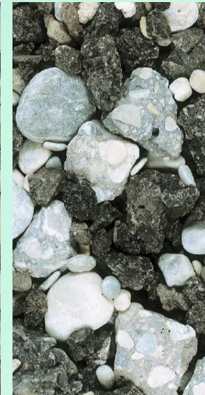
RM - Recycliertes gebrochenes Mischgranulat aus Beton, Asphalt und natürlichem Gestein
