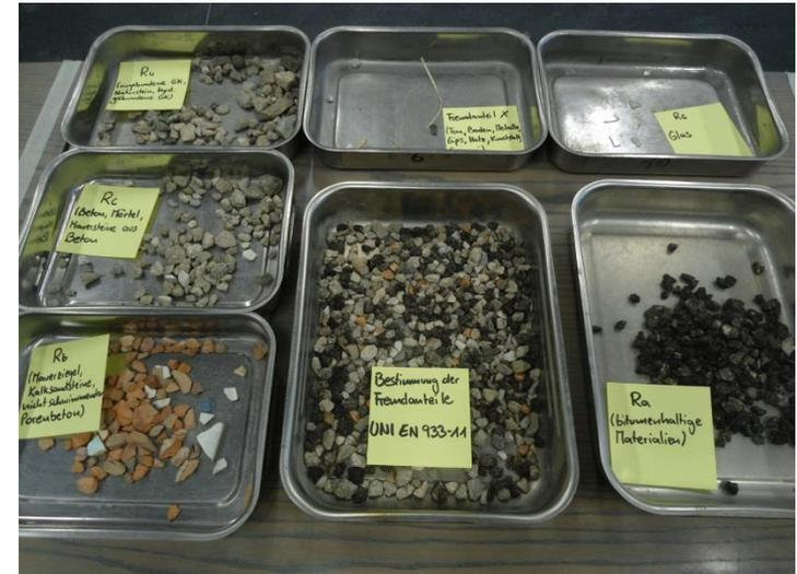
Rc Beton, Betonprodukte, Mörtel
