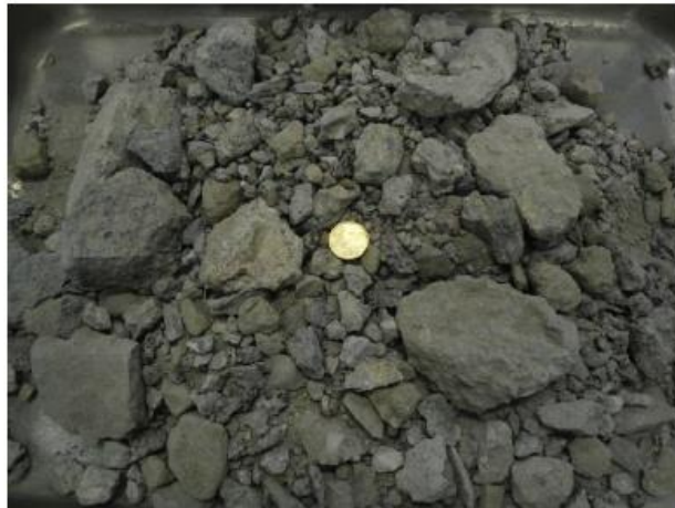
RB: vorwiegend recyceltes Betongranulat
